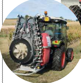
FIGURA 1 - Il prototipo di macchina irroratrice smart sviluppato nell'ambito del progetto Novagri
