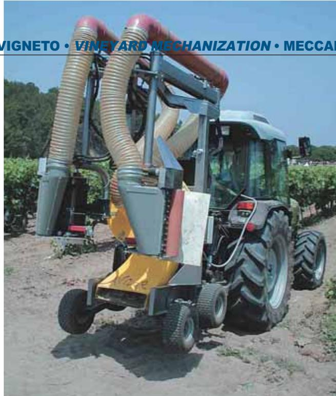
*Macchine ad aspirazione da fessura seguita da organo di taglio a barra alternativa di taglio* – In questo caso il flusso di aspirazione è fornito da un ventilatore radiale, che crea un'aspirazione di aria attraverso una fessura praticata a ridosso di un organo di taglio a barretta a taglio rettilineo alternativo tipo tosasiepi. Le foglie vengono quindi
