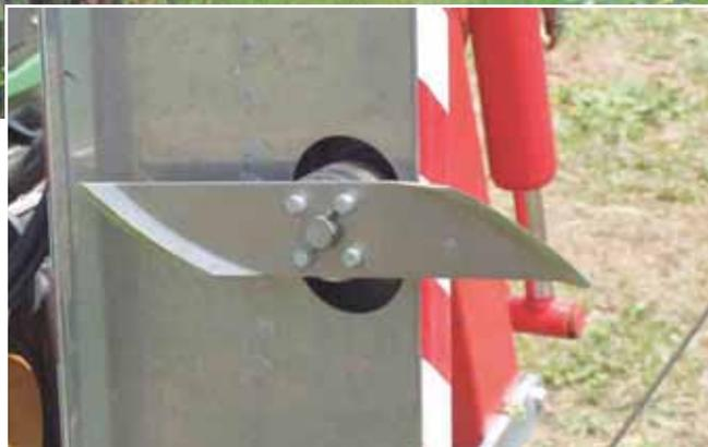
Sistema di taglio a coltelli rotanti senza riscontro/ Rotating cutting blades without reciprocal element
