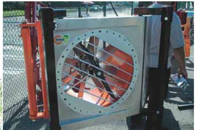
Defogliatrice ad aspirazione a griglia con lame di recisione radenti/Leaf remover using air suction and a grille to pull the leaves through the cutting blades
