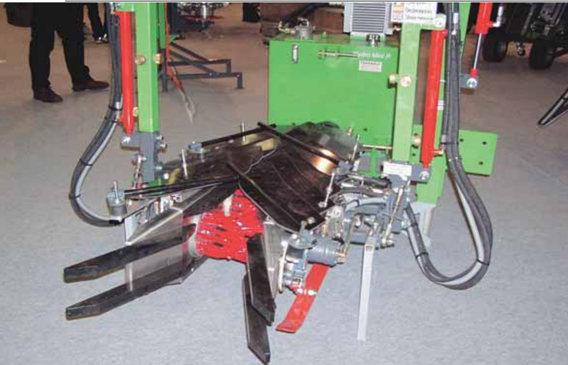
Spollonatrice a rotori orizzontali perpendicolari al filare e contrapposti ad altri controrotanti. I rotori sono dotati di flagelli di grandi dimensioni/ Shoot tipper with horizontal rotors perpendicular to the row and counter-rotors. The rotors are fitted with large flails
