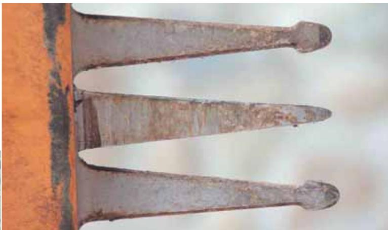
Sistema di taglio a moto alternativo con entrambe le lame mobili con direzione opposta/ Alternating motion cutting with mobile blades moving in the opposite direction
