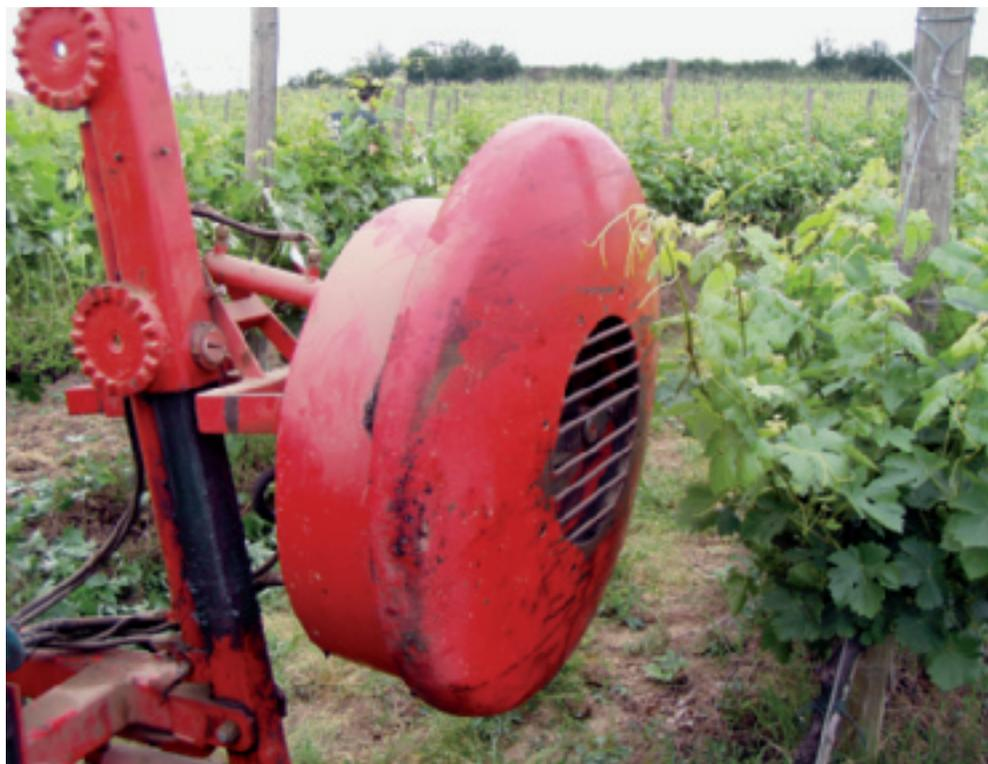
Defogliazione ad aspirazione a griglia e lame. Particolare della griglia superficiale (sopra) e del ventilatore assiale (sotto).
