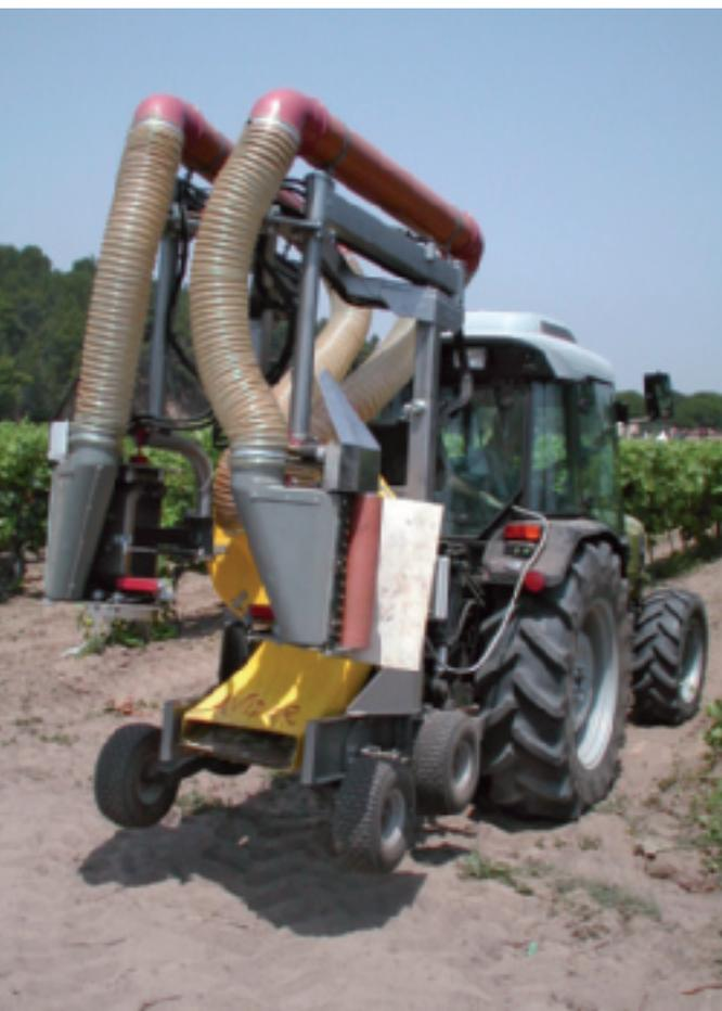
Defogliatrice Avidor ad aspirazione da fessura seguita da organo di taglio a barra alternativa di taglio: aspirazione dell'aria attraverso tubi flessibili di grande diametro.
