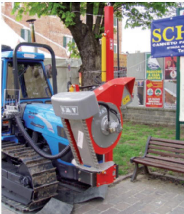
Defogliatrice BMV ad aspirazione da fessura seguita da organo di taglio a barra alternativa di taglio: notare la presenza anche di una barretta di taglio anteriore alla testata.
