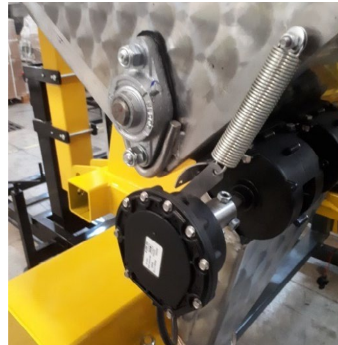
Il precisissimo contagiri permette un controllo del concime effettivamente depositato
