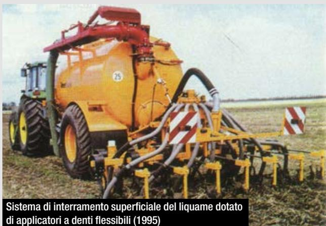
Sistema di interrimento superficiale del liquame dotato di applicatori a denti flessibili (1995)
