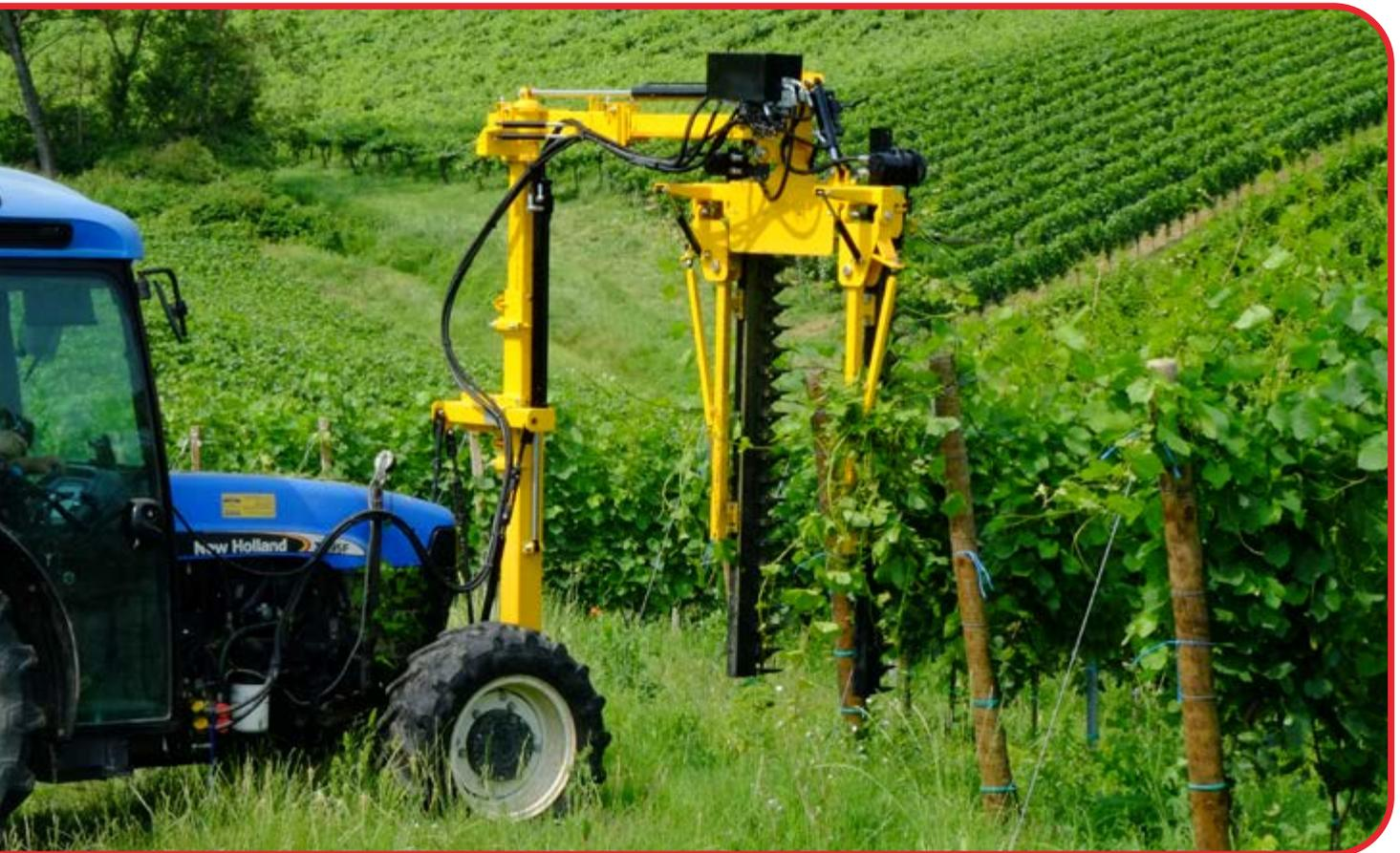
La forma ad U rovesciata degli elementi di taglio permette di gestire il filare completo a destra del trattore con facilità estrema, dovendo gestire tre soli spostamenti idraulici. Disponibile con sistema 4.0 Tecnovict, completo di software da installare su un PC del sistema informativo aziendale.
