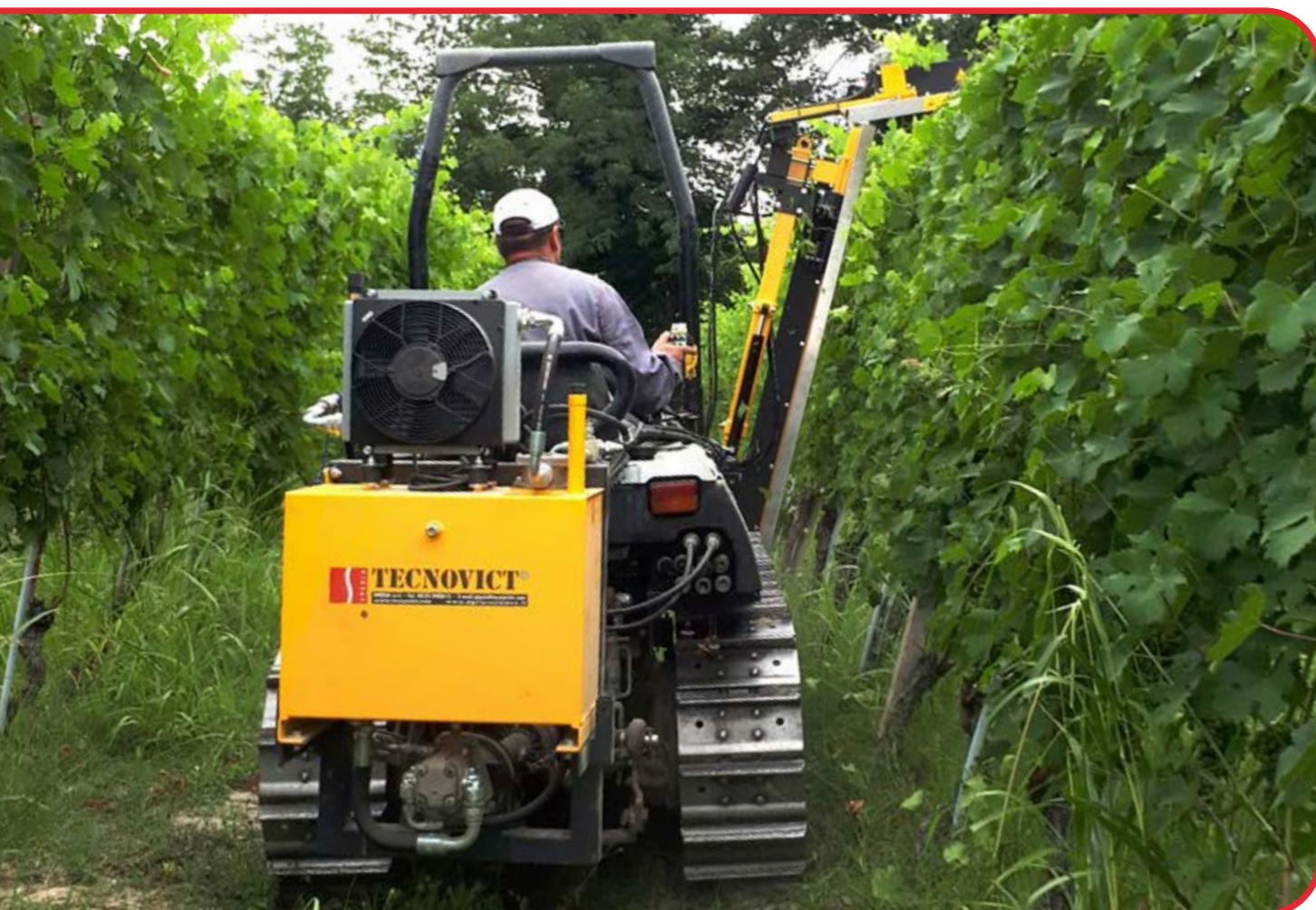
Grazie al telaio a controllo basso di cui siamo stati i precursori questa cimatrice vanta una perfetta visibilità per l'operatore, peso contenuto e baricentro particolarmente basso. Questo la rende una scelta ottimale in situazioni di viticoltura collinare anche con pendenze estreme.
