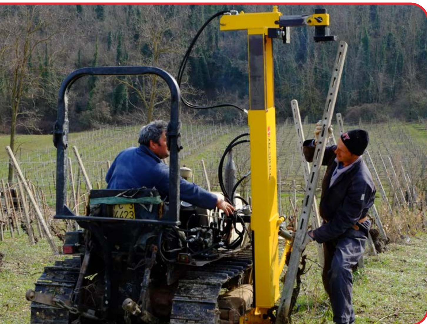
La scelta ideale per quelle aziende agricole che debbano sia allestire impianti nuovi che mantenere quelli esistenti. Può essere dotata di una pratica pinza per l'estrazione dei pali danneggiati da sostituire. Macchina ad attacco laterale adatta a trattori cingolate prive di cabina.
