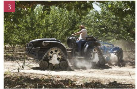
Fig. 1 - Trattrice isodiametrica realizzata dalla Pasquali, provvista di cabina e guida reversibile.
