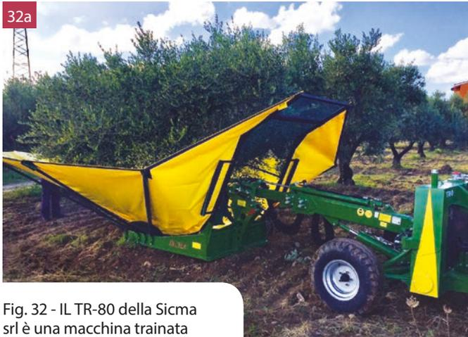
Fig. 32 - IL TR-80 della Sicma srl è una macchina trainata posteriormente ed è provvista di braccio telescopico al quale si ancorano l'ombrello rovescio e la testata vibrante multidirezionale (sinistra). La macchina ha una capacità di 30 piante/ora e viene controllata tramite un radiocomando (destra) azionato dall'operatore a terra. Si impiega principalmente per la raccolta di olive, mandorle, noci e pistacchi.
