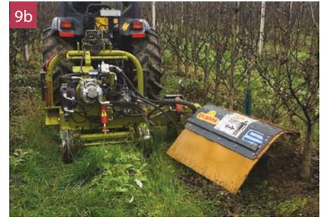
Fig. 8 - Trinciaerba interfilare portata della ditta Facma (VT) provvisto di disco interfilare a coltelli e tastatore per il rientro meccanico a molla.
