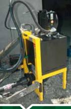
Il kit di alimentazione è costituito da un serbatoio dell'olio con pompa idraulica annessa
