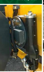
Grazie a una ralla la macchina <mark>può ruotare sul proprio asse fino a un massimo di 22°</mark>
