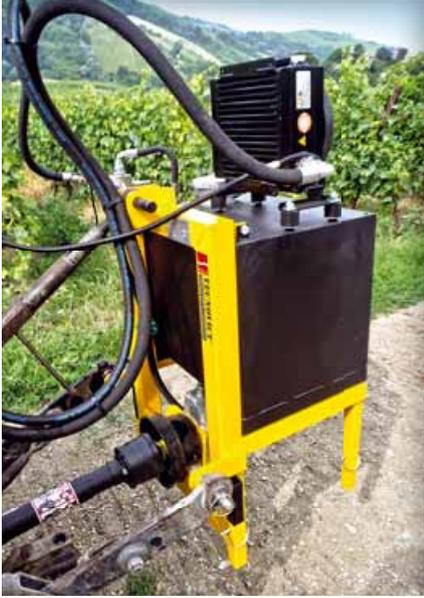
**Il gruppo idraulico posteriore consente la gestione della defogliatrice con qualsiasi trattore; è provvisto di serbatoio da 70 litri e pompa idraulica da 40 L/min**
