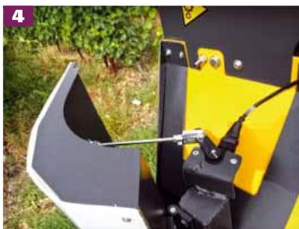
**4.** Il **potenziometro angolare** rileva e comunica alla centralina di controllo la posizione della palpebra sensibile rispetto a quella di riferimento preimpostata
