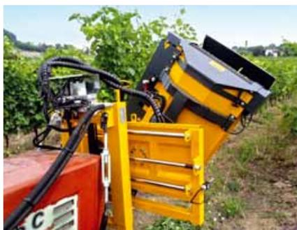
La defogliatrice ad accostamento automatico è disponibile anche con **testata reversibile** (nella versione **111 AA Rev**) mediante una robusta ralla con motore idraulico del tipo utilizzato per la rotazione delle gru da autocarro
