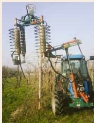
La prepotatrice a doppio rullo motrice di Colombardo con barrette laterali per rifinitura bassa
