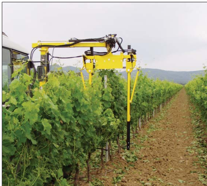
Cimatura del filare completo (vista posteriore)
