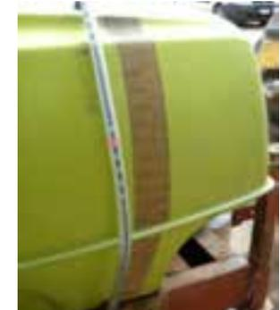
Esempio di scala di lettura funzionante dopo sostituzione a seguito del controllo funzionale
