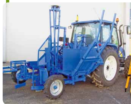
La trapiantatrice VSE, presentata al recente Sitevi 2005 di Montpellier, oltre a garantire una precisione di \pm 1 cm a 5 km/ora, è in grado di piantare tutori a una profondità di 15 cm al di sotto del piano di posa delle barbatelle.
