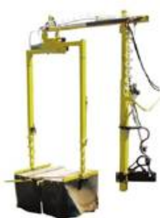
■ Attrezzatura per la distribuzione localizzata di spollonanti.
