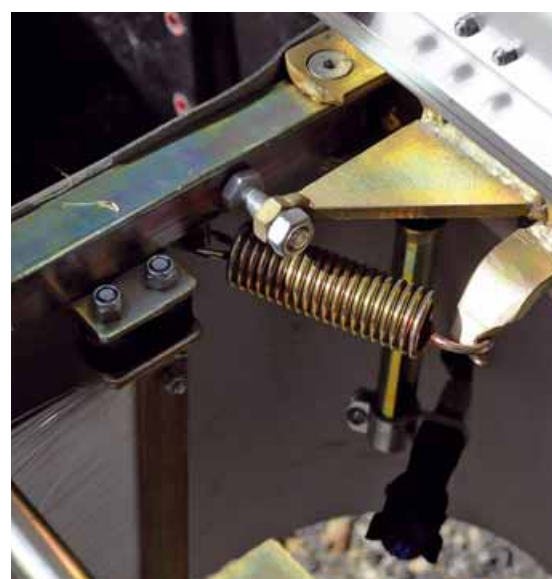
Foto 3 Dispositivo antiurto a molla
