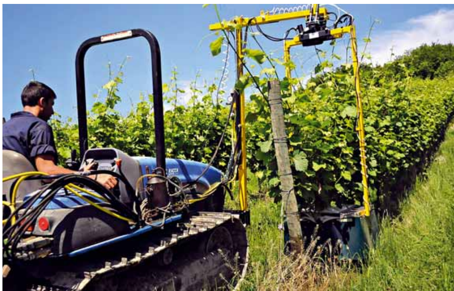
Foto 1 La spollonatrice in fase di lavoro. Si noti il telaio a tunnel che scavalca il filare
