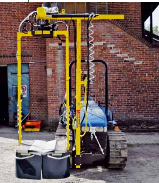
Foto A La spollonatrice chimica modello 116 della Tecnovict
