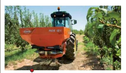
Le piccole dimensioni della serie MDS permettono di transitare anche in filari stretti. Inoltre la rapidità e facilità di rimozione del dispositivo di spandimento in banda ne permettono un utilizzo anche di campo aperto.
