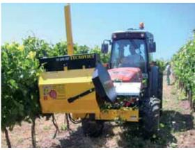
I sistemi a rateo variabile si possono applicare su diverse macchine, ammortizzando meglio i costi di acquisto delle unità elettroniche (monitor) e delle mappe di vigoria. Nella foto, all'opera una defogliatrice a rateo variabile di Tecnovict.
