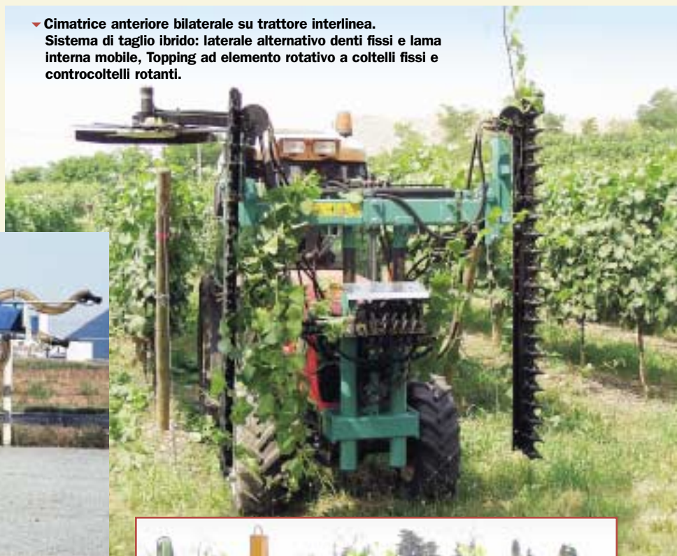
▲ Cimatrice anteriore bilaterale su trattore interlinea. Sistema di taglio alternativo a lame contrapposte. Consente di dimezzare il numero dei passaggi rispetto al sistema laterale. Buono il bilanciamento dei pesi. Notare la presenza di una sola barra di topping a destra.
