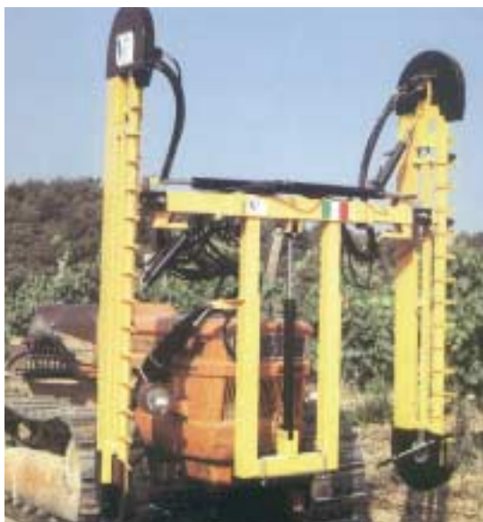
▲ Sistema di taglio rettilineo continuo (non alternativo) con denti fissi e sezioni di taglio montate su cinghia in gomma trazionata da puleggia motorizzata.
