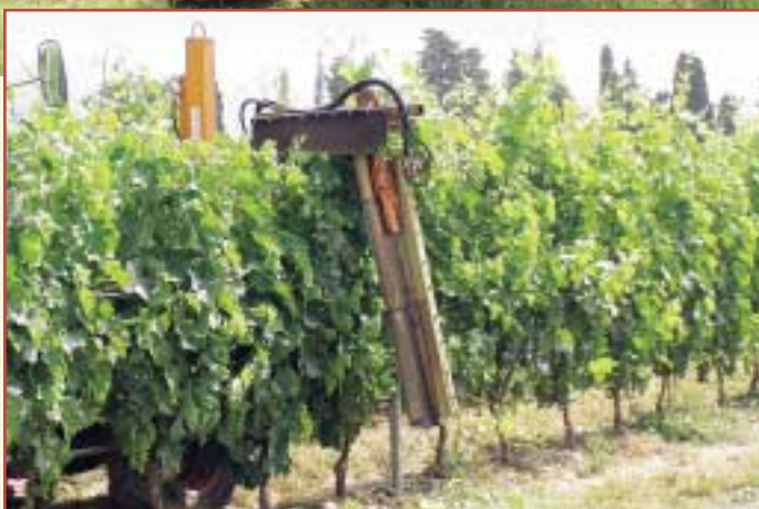
▶ Cimatrice anteriore a tunnel su trattore interlinea. Sistema di taglio a lame ad alta velocità. Il bilanciamento dei pesi non è ottimale e spesso occorre zavorrare il trattore nella parte posteriore sinistra.
