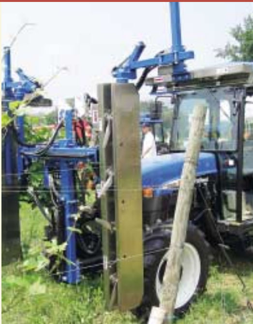
▼ Cimatrice anteriore bilaterale su trattore interlinea. Sistema di taglio ibrido: laterale alternativo denti fissi e lama interna mobile, Topping ad elemento rotativo a coltelli fissi e controcoltelli rotanti.
