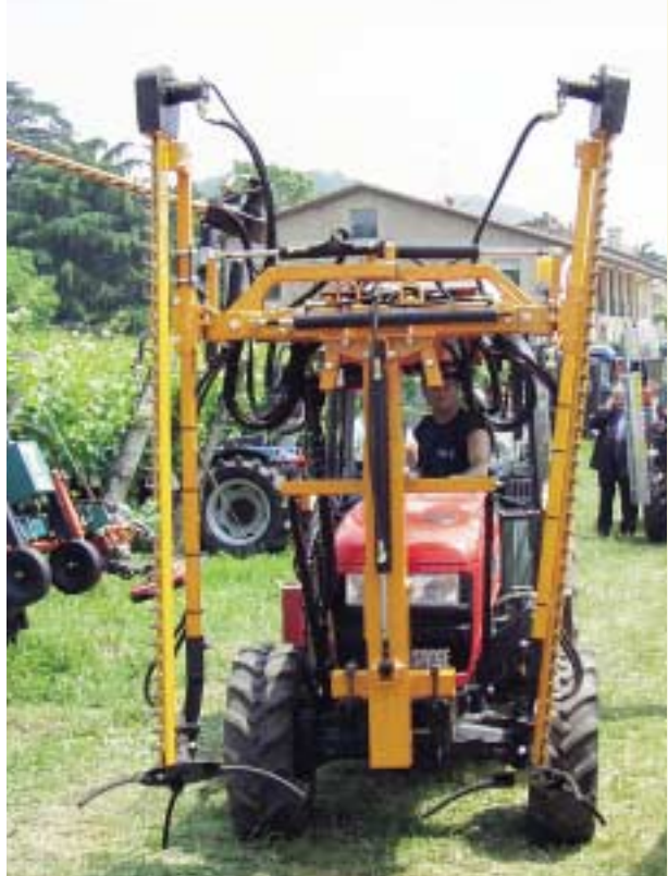
▲ Cimatrice anteriore bilaterale su trattore interlinea. Sistema di taglio alternativo a lame contrapposte. Consente di dimezzare il numero dei passaggi rispetto al sistema laterale. Buono il bilanciamento dei pesi. Notare la presenza di una sola barra di topping a destra.
