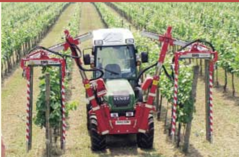
▲ Cimatrice a doppio tunnel, sistema di taglio a coltelli veloci.
