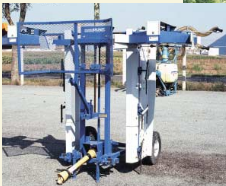
▲ Cimatrice posteriore con attacco ai tre punti del sollevatore della trattrice, trasmissione del moto meccanica, elementi di taglio a lame veloci a disposizione radiale per energia centrifuga.
