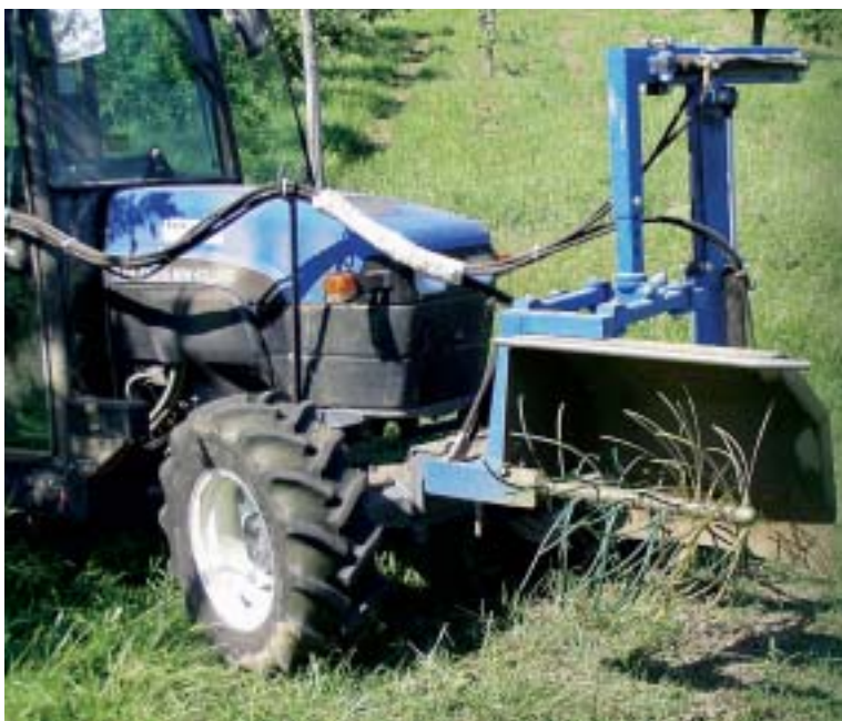
◀ Foto 6 - Spollonatrice anteriore con flagelli a filo di grande diametro
