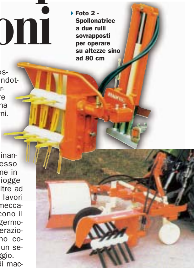
▲ Foto 2a - Spollonatrice ad asse orizzontale parallelo al filare con flagelli a spazzole di gomma telata
