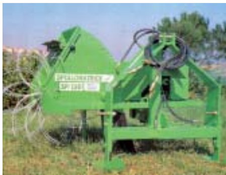
▲ Foto 3 - Prima spollonatrice italiana a rotore orizzontale parallelo al filare e flagelli in fili di nylon da 3 mm di diametro
