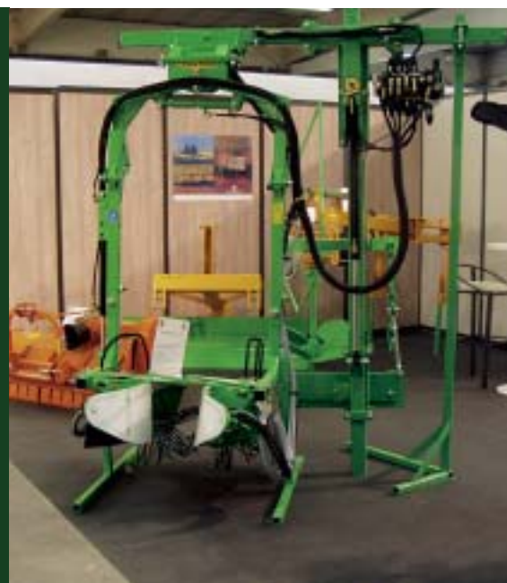
◀ Foto 6 - Spollonatrice anteriore con flagelli a filo di grande diametro
