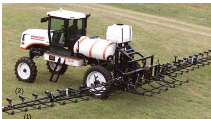
Figura 3 Distribuidor VRT de N em tempo real. A taxa de aplicação em (1) é função do teor de clorofila estimado em (2). (Fonte: Oklahoma State University)
