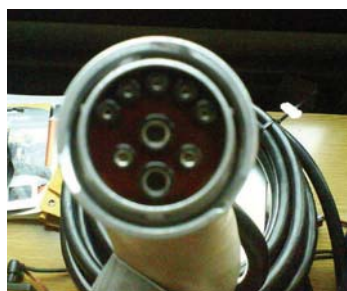
Figura 4 Tomada standard ISOBUS que permite a comunicação e controlo entre equipamentos de diferentes fabricantes. (Fonte: Farmerjo169 em http://commons.wikimedia.org )
