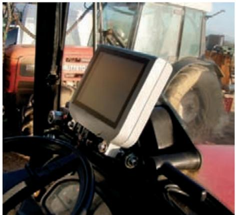
posizione dell'apezzamento ed erogare l'esatto quantitativo di concime. Sul terminale vengono caricate le mappe di prescrizione che saranno così visibili al trattorista unitamente alla posizione del mezzo. Il software, riconosciuto in che zona ci si trova ad operare, dà l'input allo spandiconcime per l'esatta erogazione della dose. Inoltre, sulla macchina stessa è installata una memory card che tiene traccia di tutto ciò che si è fatto (cosa si è distribuito e con quale dose).
